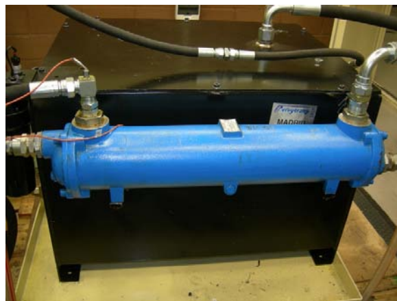
Figura 3.3: Intercambiador de calor con sensores de temperatura.
