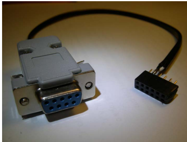
Figura 2.26: Cable de conexión entre NI USB-8473 y placa CEREBOT.
