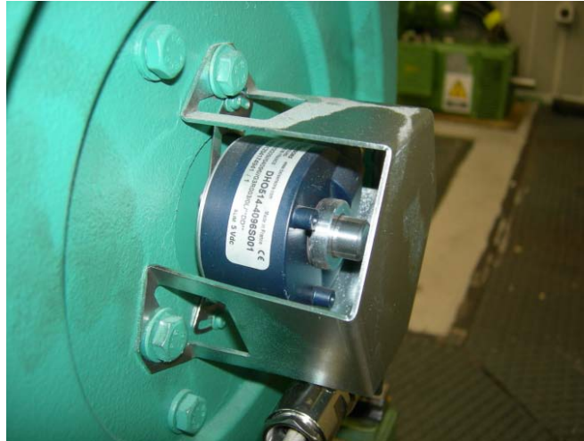
Figura 3.10: Encoder asociado al eje de un motor.
