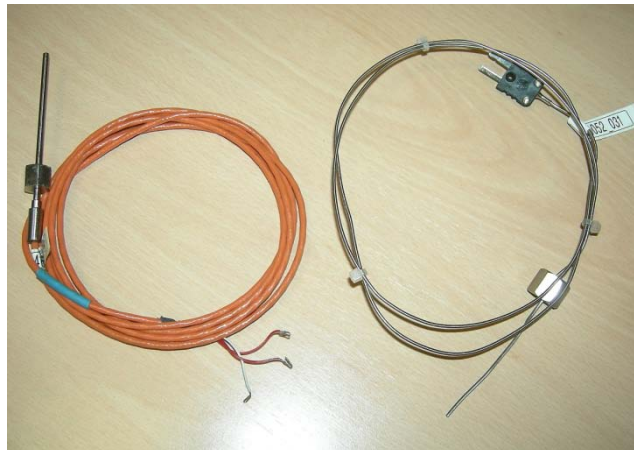
Figura 3.6: Sensores de temperatura, resistivo y termopar.
