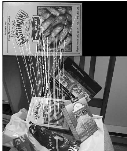
Figura 3.21: Ejemplo Básico del Algoritmo SURF, Aplicado Sobre una Zona Parcial de una Imagen, Aplicada una Rotación.
