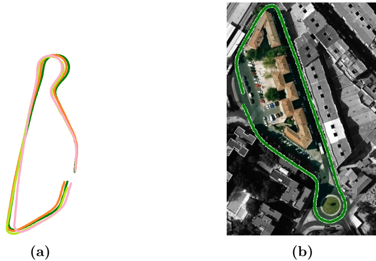
Figura 6.12: Resultados del Algoritmo de Partida. (a) Resultados Superpuestos con Calibración del Yaw , Pitch , Roll , sin Comprobación de Puntos en Calzada. (b) Superposición sobre el Mapa de Satélite Con Calibración del Yaw , Pitch , Roll , sin Comprobación de Puntos en Calzada.
