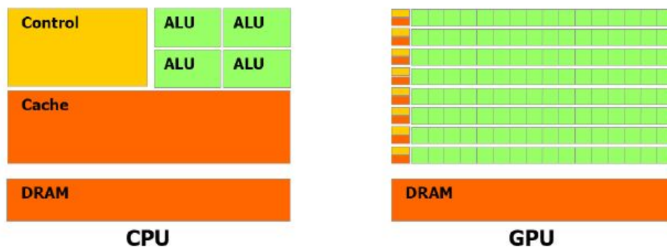
Figura 3.13: Filosofía de Diseño de una CPU (izq) y una GPU (der)
