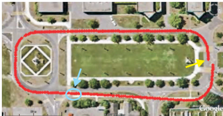
Figura 2.2. Estimación de una trayectoria cerrada con el método propuesto por Scaramuzza et ál.
