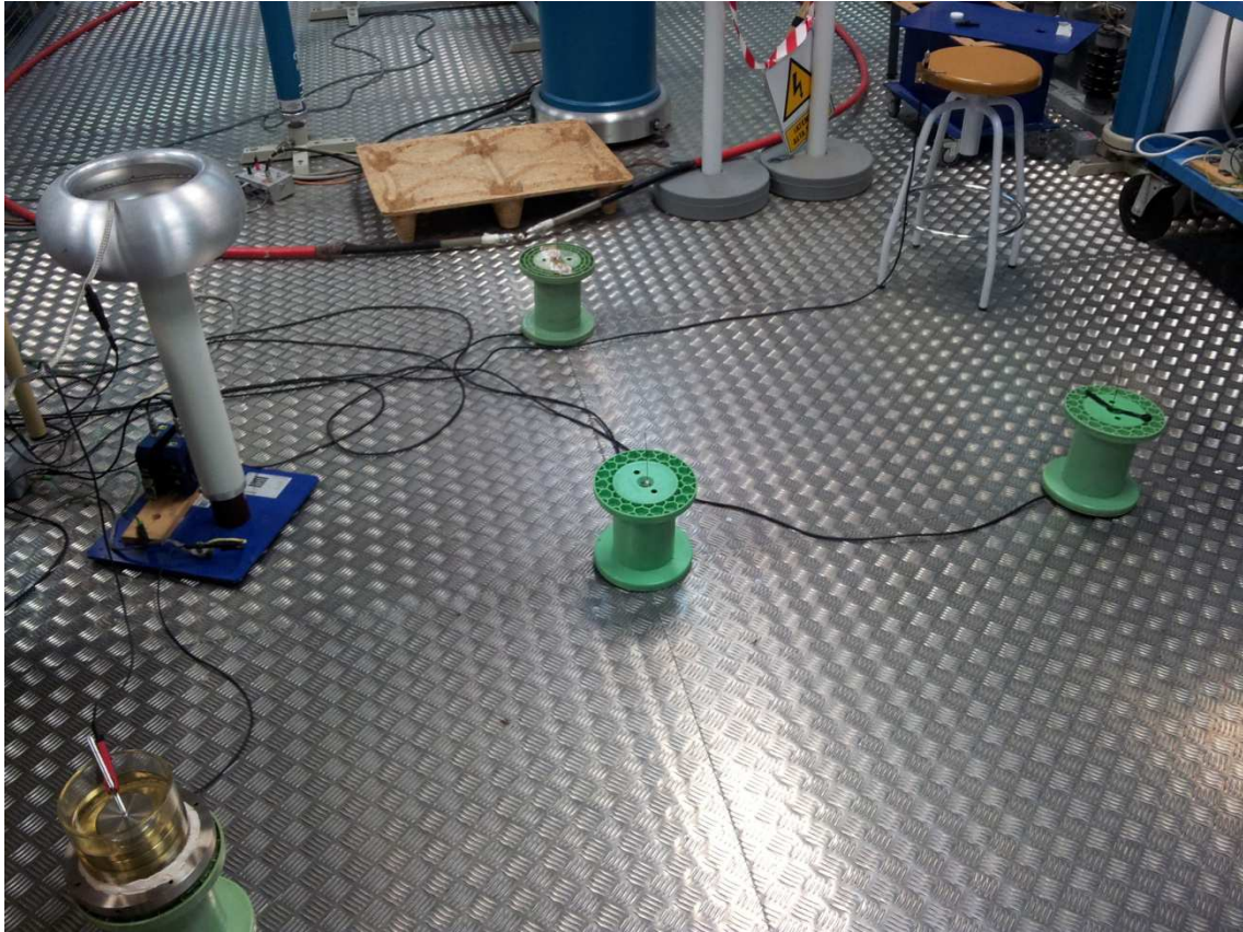
Figura 52. Antenas y fuente de DP's durante las mediciones en el laboratorio.
