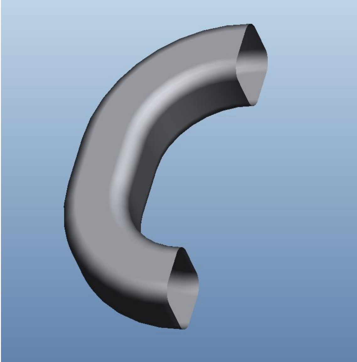
Figura 7.7: Diseño de la tubería media-luna 600 mm.
