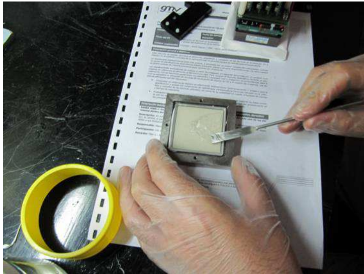
Figura 10.5 Aplicación de la silicona óptica
