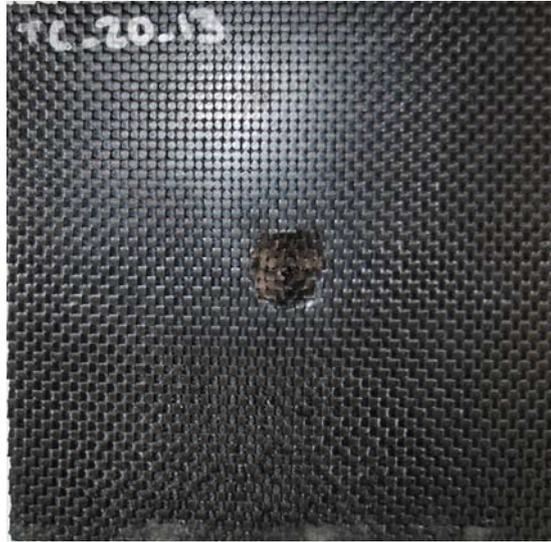
Figura 5.39 Daño producido por impacto en una estructura sándwich de carbono/epoxi/panal de abeja sometidas a impacto de 15 J.
