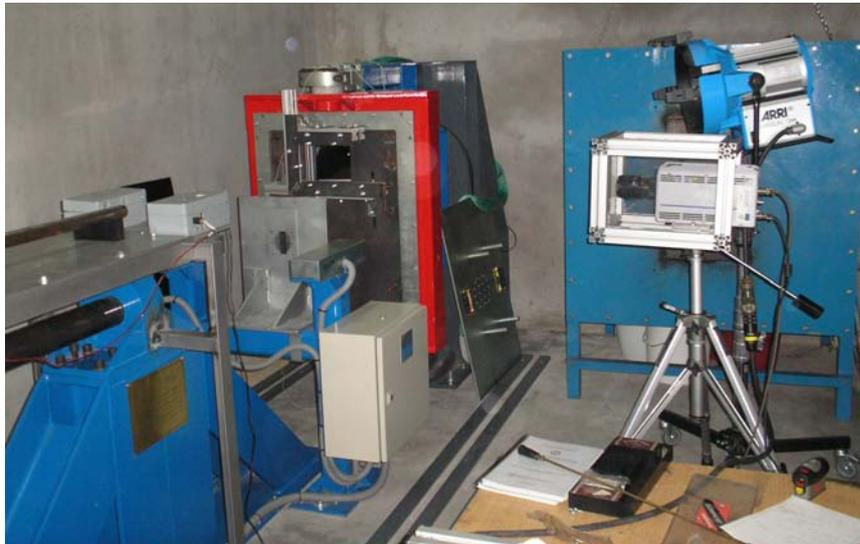
Figura 3.8 Detalle del foco y de la cámara ubicada sobre la sección de impacto del cañón de gas.
