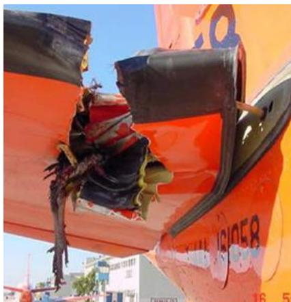
Figura 2.9 Daño por impacto en el borde de ataque de una aeronave [Ilcewicz, 2006].
