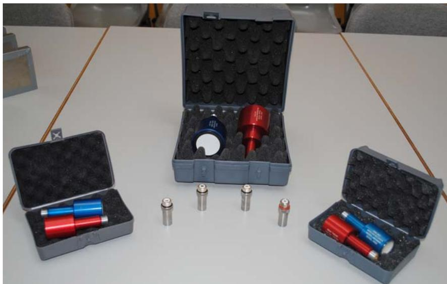
Figura 4.9 Transductores del equipo de ultrasonido con acoplamiento en aire.
