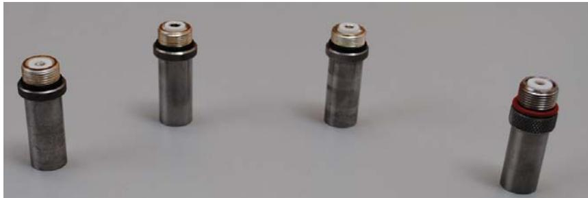
Figura 4.8 Transductores para equipo de ultrasonido con acoplamiento en agua.
