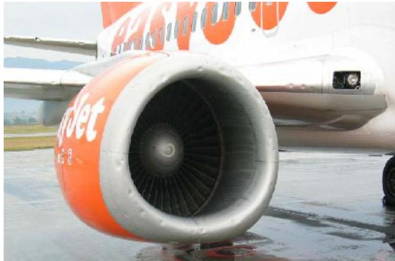
Figura 2.9 Daño en la góndola de motor turbofan por impacto de hielo [Ilcewicz, 2006].
