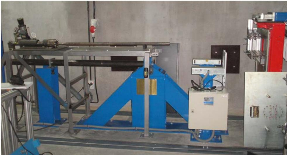
Figura 3.7 Cañón para pruebas de impacto balística SABRE Ballistics A1G+.
