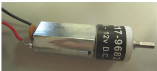
**Figura 5.8. Motor con reductora MFA/Como Drills 941D41**
