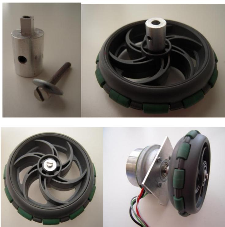
**Figura 4.8. Solución acoplamiento rueda-motor**
