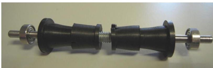
**Figura 5.11. Eje o barra del dribbler 2011**
