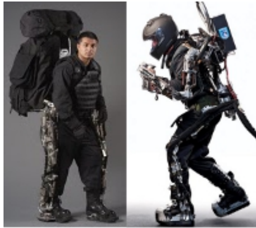
Figura 1.3: De izquierda a derecha BLEEX y SARCOS. Imágenes de [37] y de la web de Raytheon, respectivamente.
