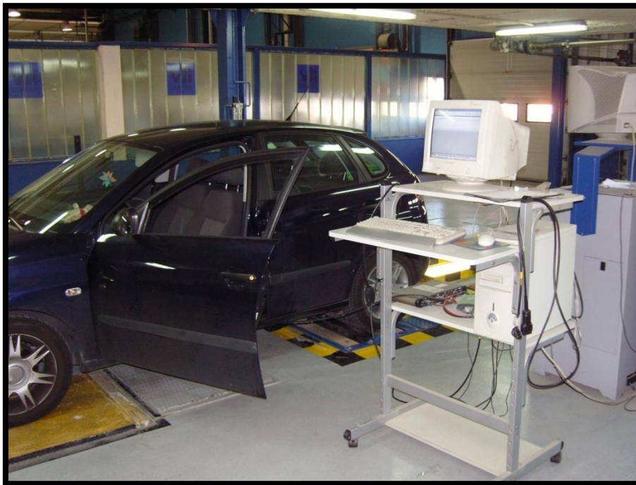
Figura 89. Situación de vehículo en prueba de diagnóstico mediante EOBD
