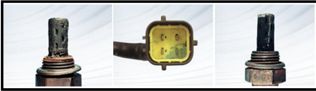
Figura 52. Ejemplos de imágenes de sondas lambda deterioradas
