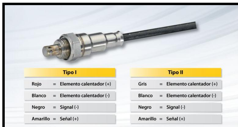
Figura 45. Asignación de cables para sondas lambda de dióxido de titanio
