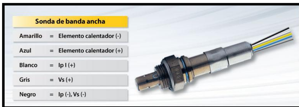
Figura 49. Asignación de cables para sondas lambda de banda ancha
