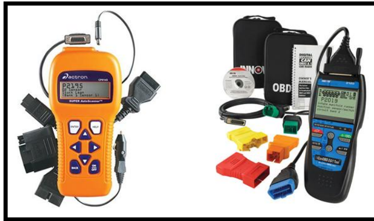
Figura 82. Sistemas de tratamiento de información OBD
