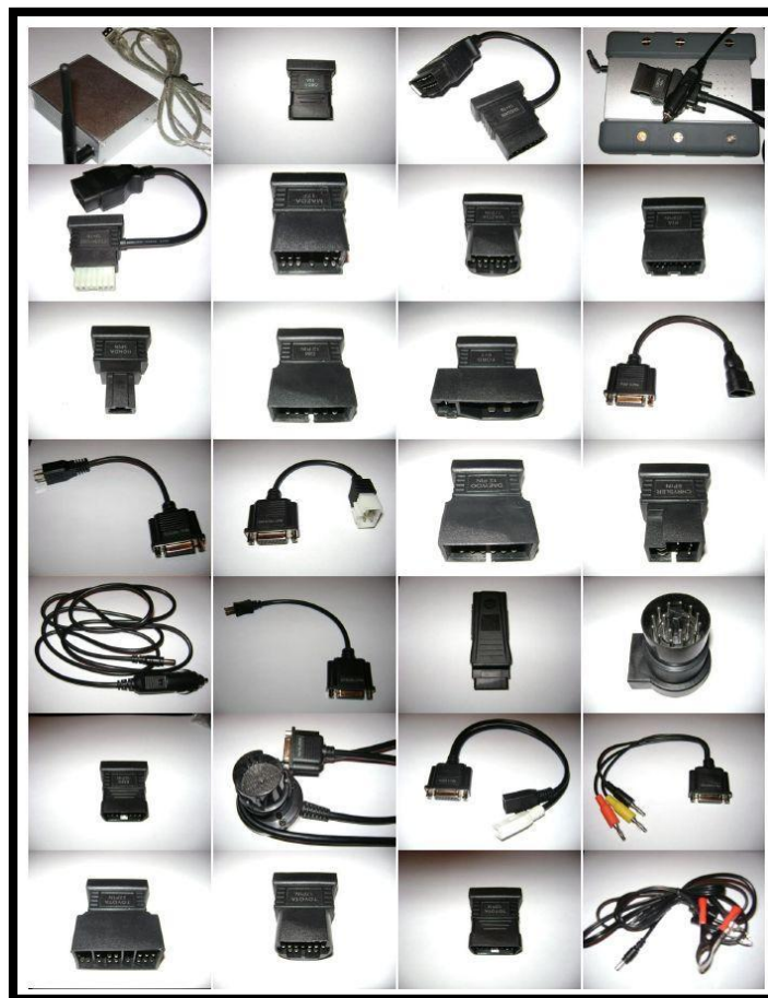
Figura 86. Tipos de conectores EOBD
