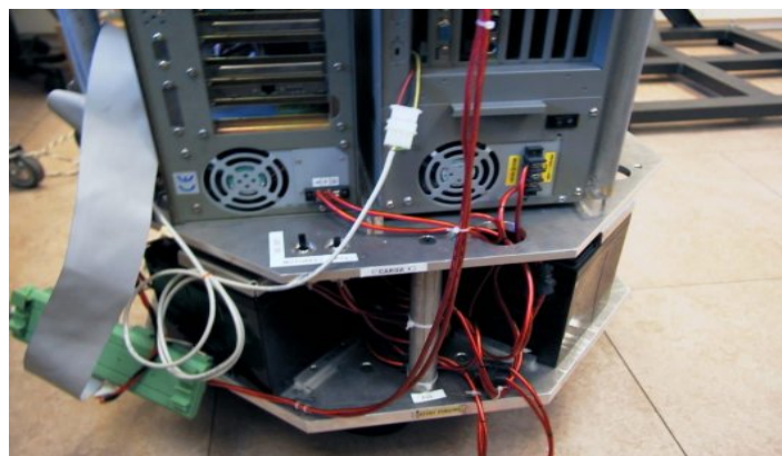
Figura 3.19.- Sistema de procesamiento - PCs a bordo.
