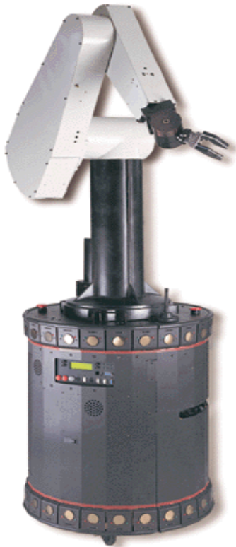
Figura 2.3.- Manipulador móvil (Base: Nomadic XR4000 and Manipulator Arm: PUMA 560).
