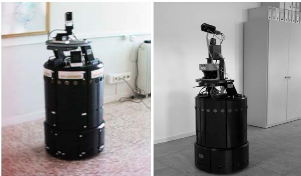
Figura 2.32.- Base móvil RWI-B21.
