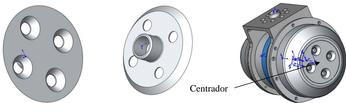
Figura 4.39.- Izqda. y centro vista 3-D del centrador tipo 1. Dcha. Posición en la articulación.
