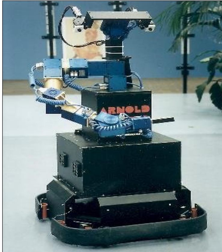
Figura 2.26.- El manipulador móvil ARNOLD, con rasgos antropomórficos.
