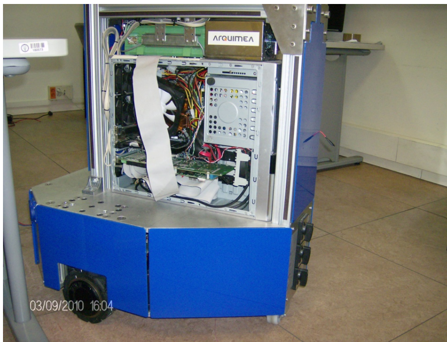
Figura 7.4.- Carcasas extraíbles (en azul) para la mejora de acceso a los elementos del sistema de la nueva generación del manipulador móvil MANFRED (MANFRED-II).
