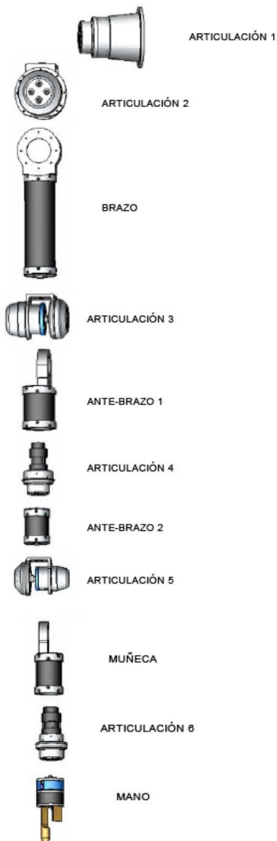
Figura 4.50.- Estructura del brazo manipulador.
