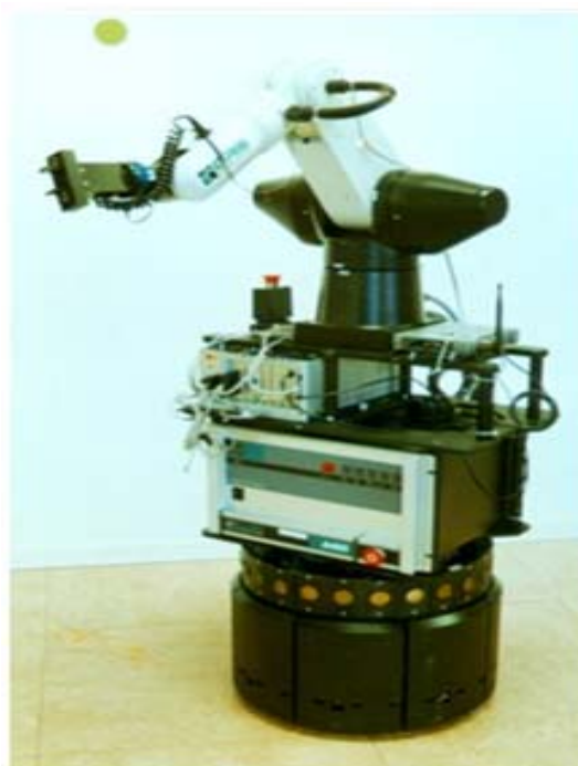
Figura 1.1.- Manipulador móvil OTILIO.
