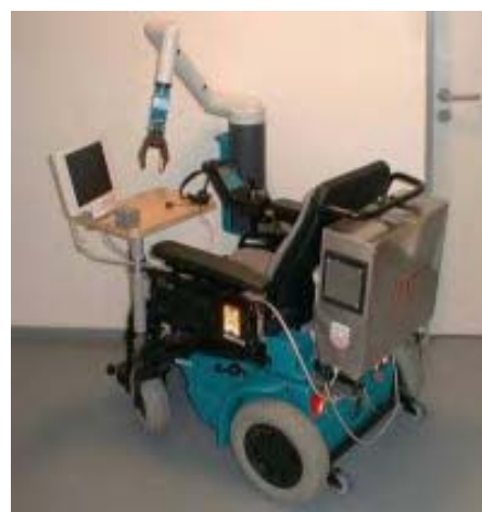
Figura 2.7.- Manipulador móvil IMMEDIATE, para asistir a pacientes discapacitados.
