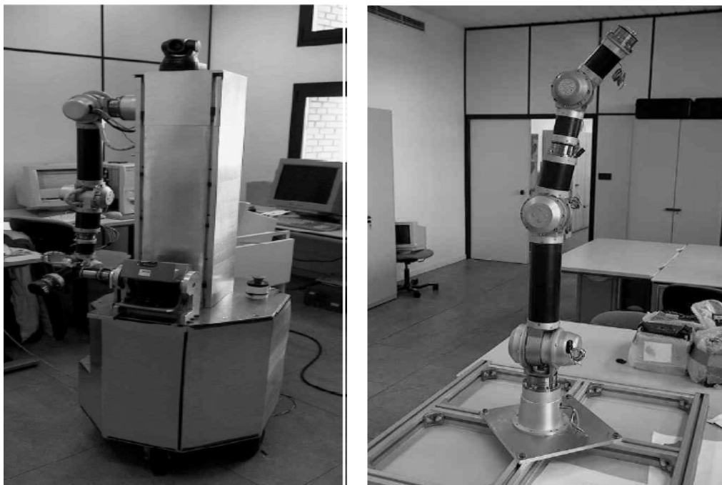
Figura 2.35.- Izq. Manipulador móvil MANFRED y Dcha. su brazo UC3M-LWR-1.
