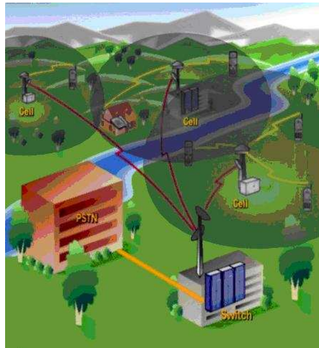
Fig 2.4 Diagrama simplificado funcionamiento telefonía móvil
