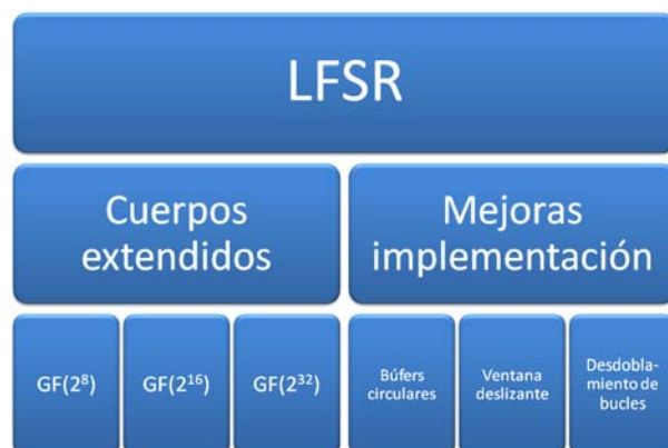
Figura III.1: Esquema de las mejoras a la implementación de LFSRs presentadas en este capítulo
