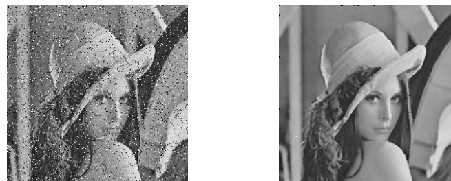
Figura 3.14 - Lenna con ruido sal y pimienta y resultado tras aplicar el filtro de medianas
