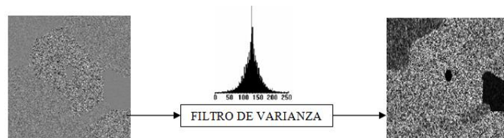
Figura 4.5 – Aplicación de un filtro de varianza para segmentar por textura
