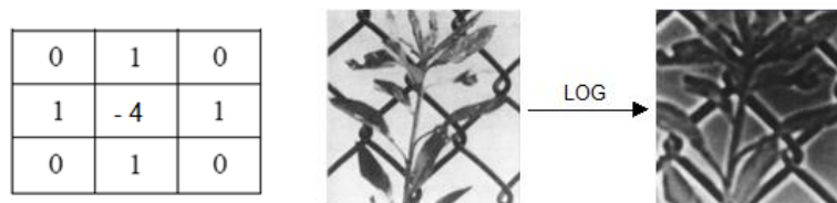
Figura 4.8 – Ejemplo de máscara Laplaciana y aplicación de un filtro LOG
