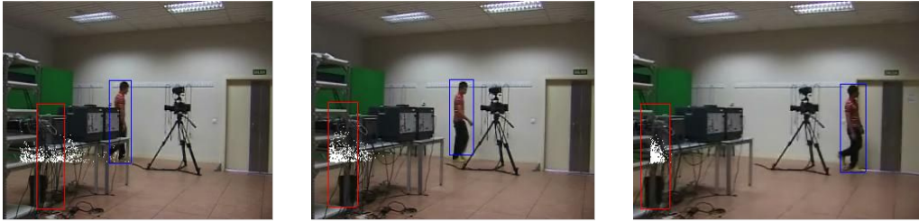
Figura 45. Funcionamiento del algoritmo básico, secuencia 5. El algoritmo pierde la pista del objetivo para el resto de secuencia, debido a la oclusión en los frames 671-846 durante el movimiento de cámara.
