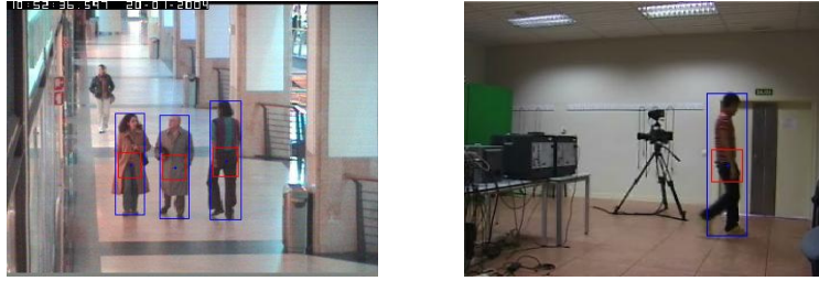
Figura 37. Medida de calidad Q_2 , ejemplos de localización estimada precisa. El rectángulo azul representa el ground truth del objeto a seguir, mientras que el cuadrado rojo representa la región en la cual la salida del tracker es clasificada como precisa y obtiene un valor 1 en el ratio de detección; fuera de esta área el valor obtenido es 0.
