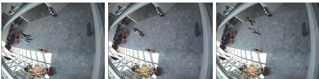
Figura 56. Asociación de los objetivos tras una oclusión en multitracking . Es importante que el algoritmo no los confunda y sea capaz de determinar quién es quién tras la "fusión" que se produce en el encuentro.
