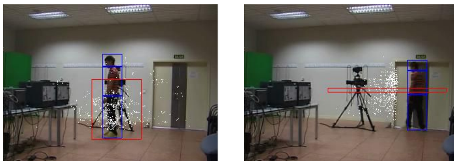
Figura 52. Inestabilidad de la extensión 4. Deformación de la región de detección en la secuencia 4.
