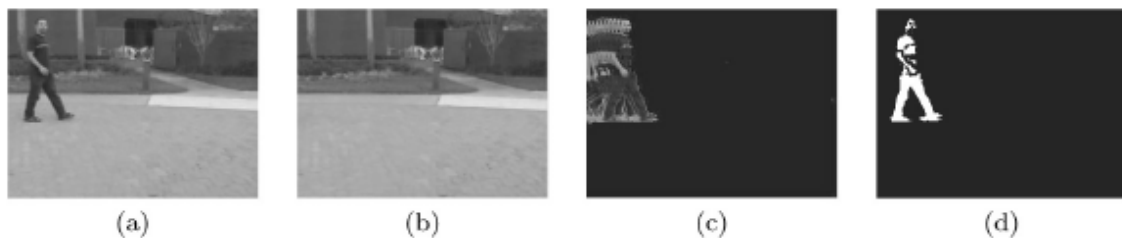
Figura 9: Modelo de mezcla de gaussianas para sustracción de fondo. (a) Imagen de una secuencia en la que una persona camina por la escena. (b) La media de las gaussianas de mayor peso en la posición de cada píxel. Estas medias representan los colores más persistentes temporalmente en cada píxel y deberían representar el fondo estacionario. (c) Las medias de la gaussiana con el segundo mayor peso. Estas medias representan colores observados menos frecuentemente. (d) Resultado de la sustracción del
