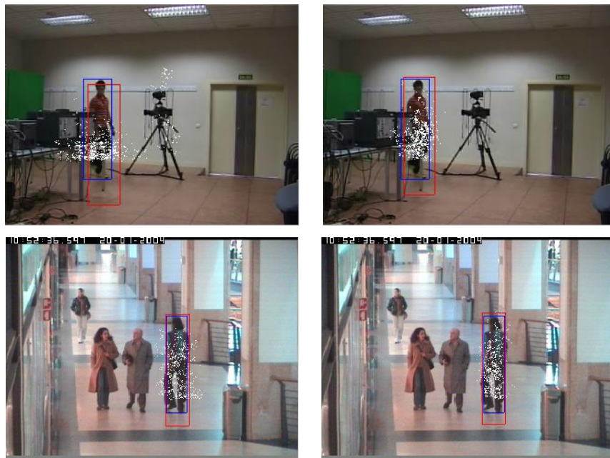
Figura 46. Comparación entre la versión básica y la extensión 1. Imágenes extraídas de las secuencias 4 y 6. Se puede observar en ambas situaciones como dicha extensión reduce los outliers y concentra las partículas en el objetivo.
