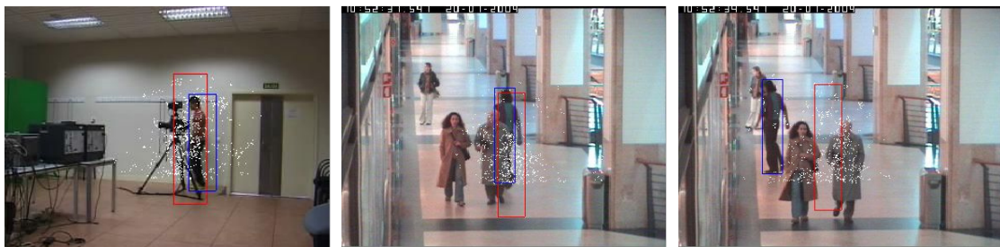
Figura 50. Inestabilidad de la extensión 3: histograma HSV. En la primera imagen se puede observar la expansión de las partículas y las distracciones que acarrea en la secuencia 4. En las otras dos imágenes se representa la inestabilidad y la posterior pérdida del objetivo en la secuencia 6.
