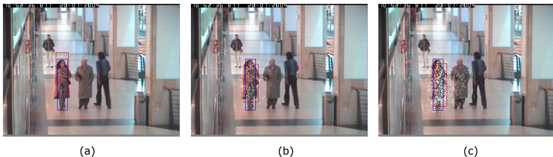
Figura 25. Ejemplos de tracking con diferente número de partículas. (a) N_s = 100 , (b) N_s = 500 , (c) N_s = 2000 . Se puede apreciar la mejora que supone emplear 500 partículas respecto a emplear 100 (el
