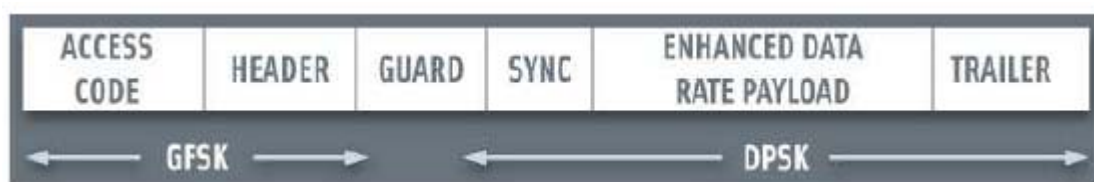
Figura 8 – Formato estándar de paquetes para la transferencia de datos mejorado
