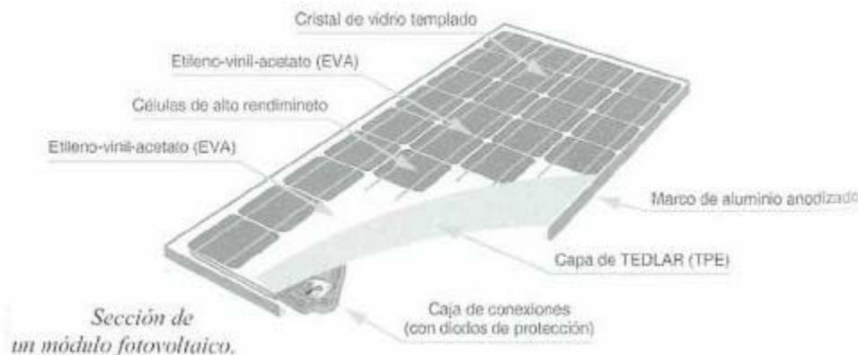
**Figura 12. Sección de un módulo fotovoltaico.**
