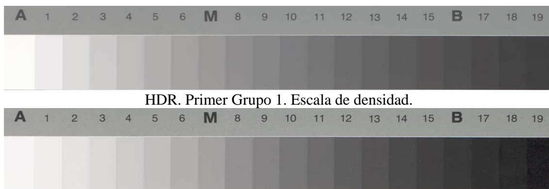
Figura 12 Visibilidad de problemas tonales sobre la escala de parches de densidad Q13.
