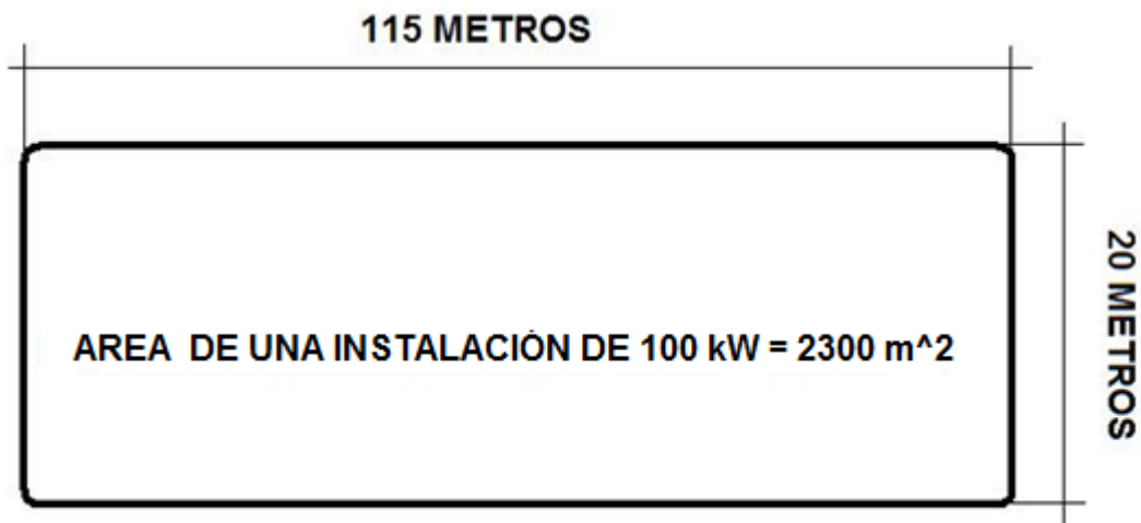
Figura 13. Área de una instalación de una planta solar 100 kW
