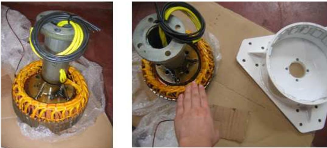
**Figura 77. Detalle del generador de imanes permanentes a estudiar**
