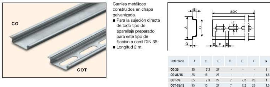
**Figura 106. Perfil DIN para anclaje de protecciones**
