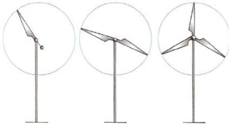
Figura 2.3.- Rotor de eje horizontal tipo hélice (monopala, bipala y tripala)
