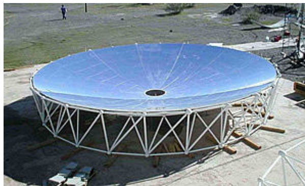
Figura 8. Imagen de un concentrador de 8'5 metros de diámetro de SBP.
