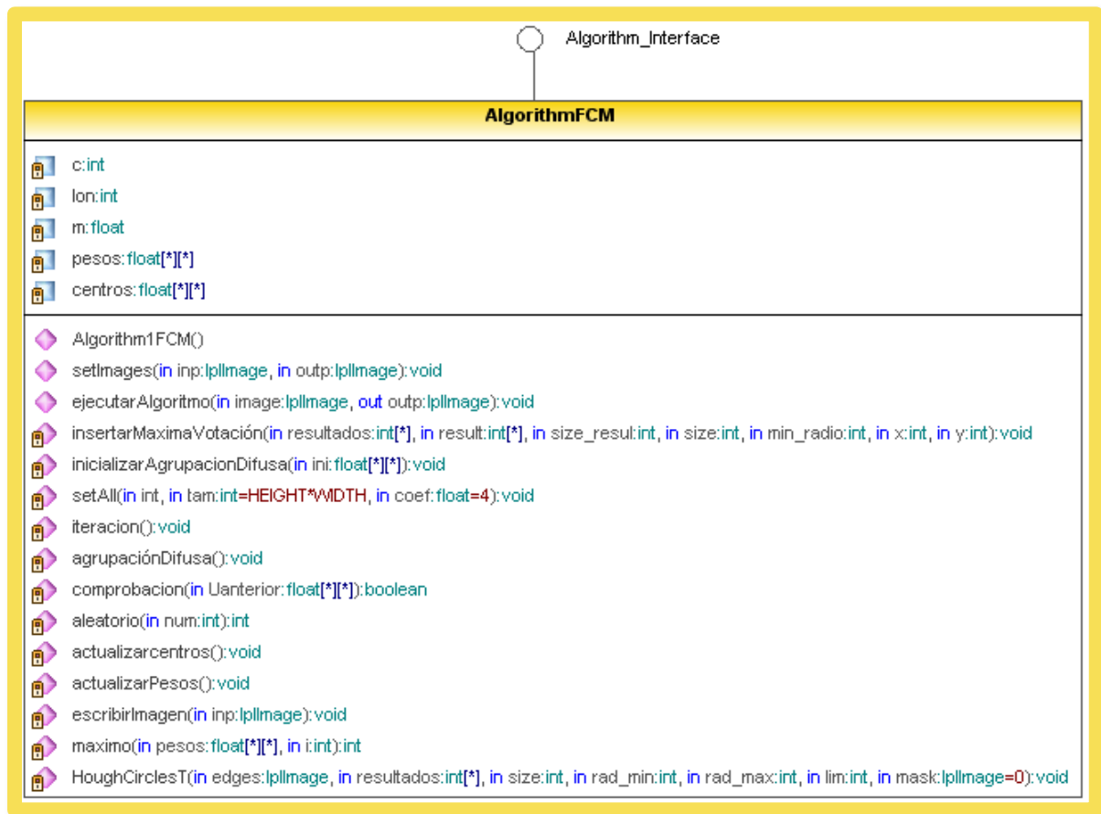
Figura 44 - Diagrama de Nivel 2: Componente Algoritmo 2 - Clase AlgorithmFCM
