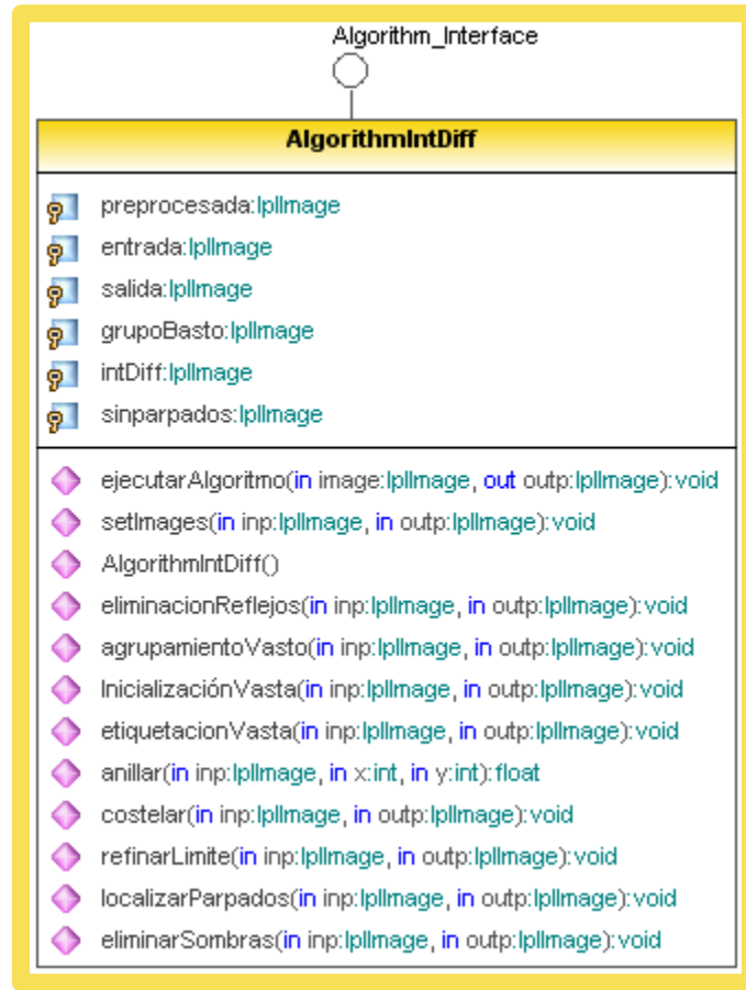
Figura 45 - Diagrama de Nivel 2: Componente Algoritmo 3 - Clase AlgorithmIntDiff
