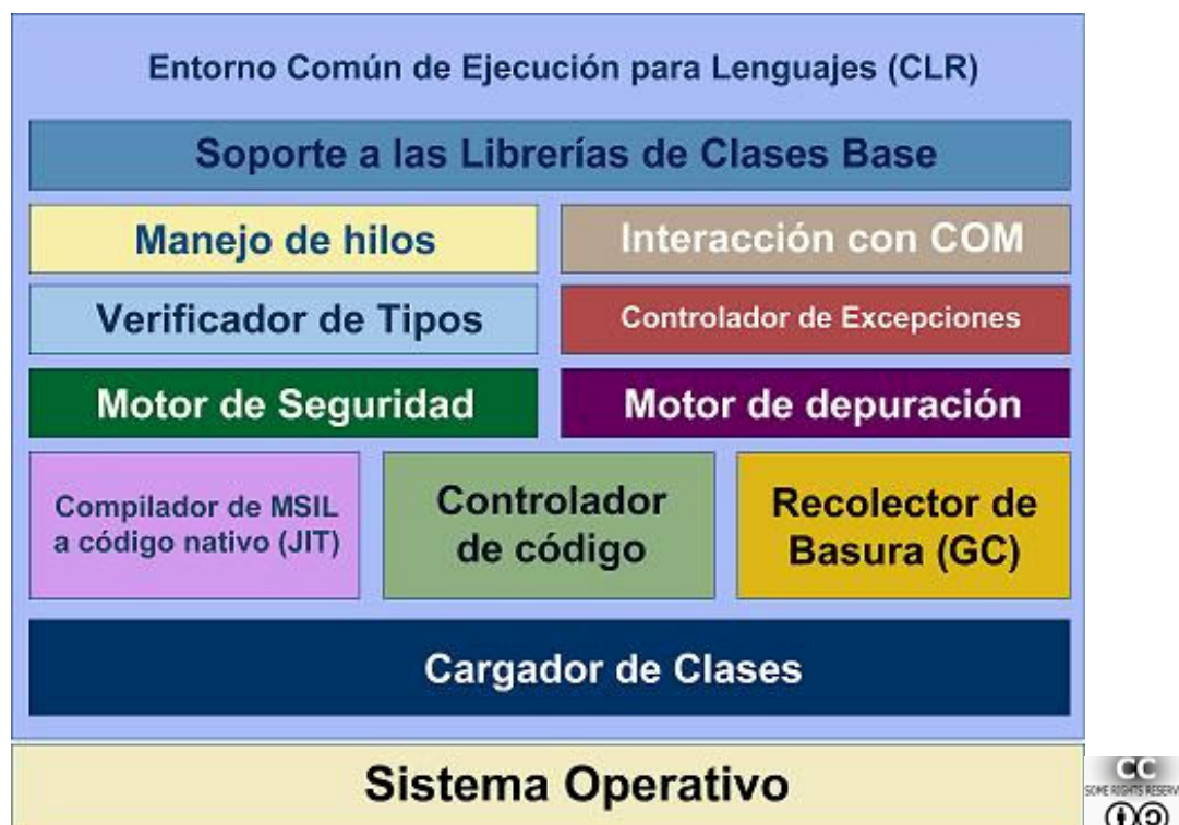
Figura 2.3.b: Estructura interna del entorno de ejecución en lenguaje común (CLR)
