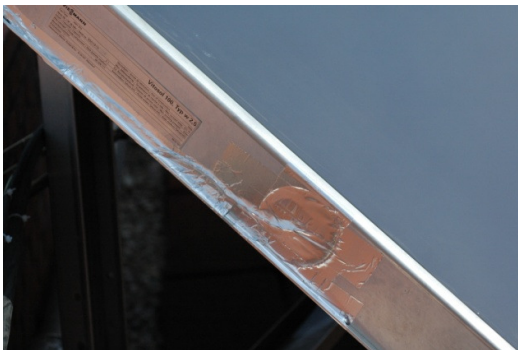
Figura 4-25: Termopar situado en la cara posterior de la superficie absorbedora
