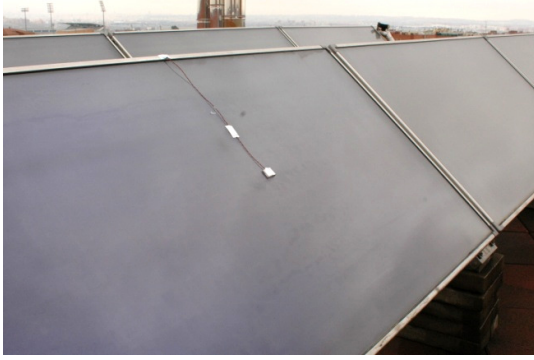
Figura 4-23: Termopar situado en el cristal del captador
