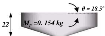
Fig. 6. Geometría y dimensiones de los proyectiles cónicos empleados en las simulaciones numéricas
