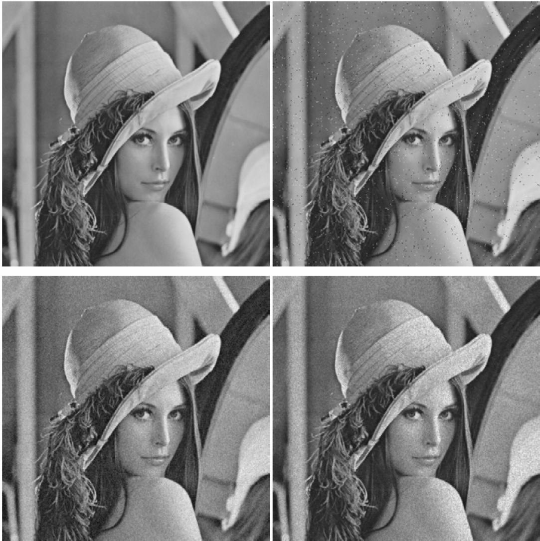
Fig. 3.18 Evaluación de las imágenes "Lena" con distintos tipos de ruido: - Arriba a la izquierda: imagen original "Lena", 512 x 512, 8 bits/píxel - Arriba a la derecha: imagen con ruido impulsivo sal y pimienta, MSE=225, Q=0,6494 - Abajo a la izquierda: imagen con ruido aditivo gaussiano, MSE=225, Q=0,3891 - Abajo a la derecha: imagen con ruido multiplicativo, MSE=225, Q=0,4408
