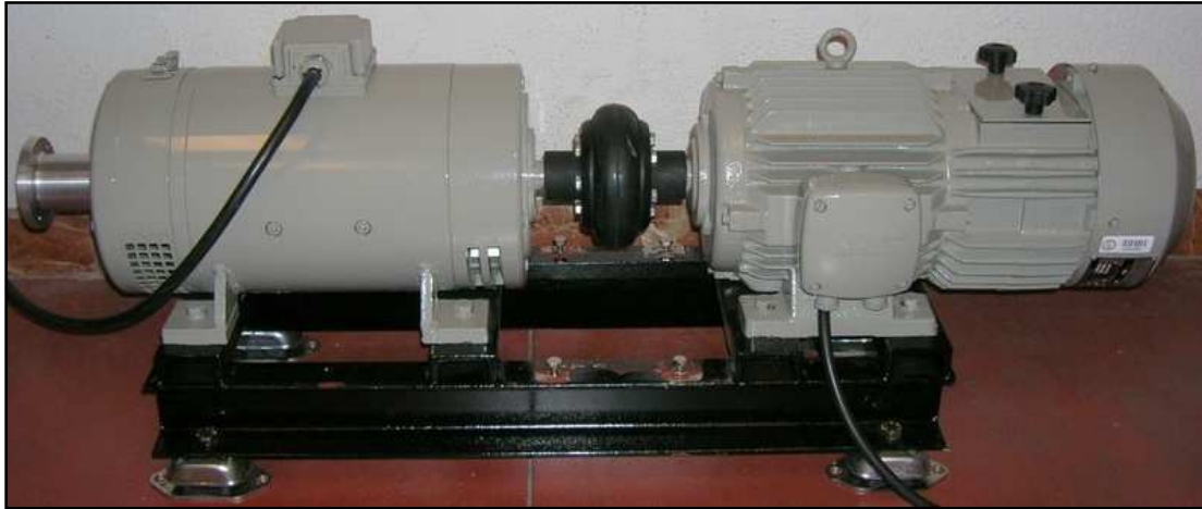
Fig. 16. Motor DC, acoplamiento mecánico, motor AC
