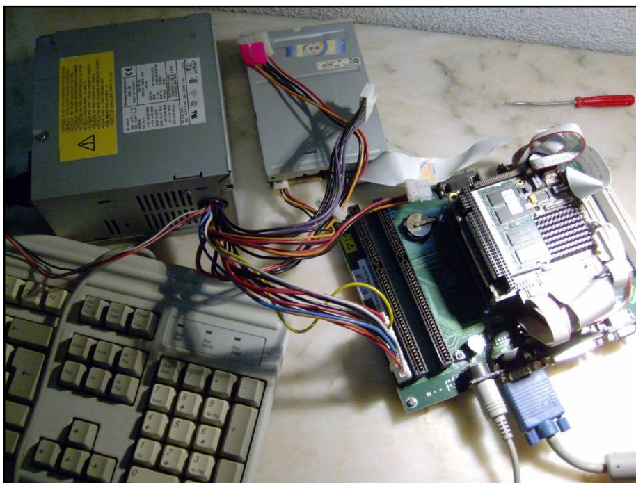
Fig. 29. PC-104. De izquierda a derecha y de arriba hacia abajo: (Fuente alimentación, unidad de disquete, teclado y placa base) Conexión de teclado y Monitor (clavija azul) en la parte de abajo a la derecha
