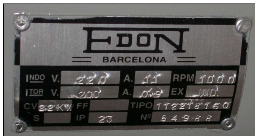
Fig. 17. Placa de características del motor DC
