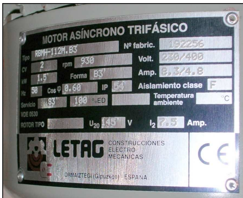
Fig. 18. Placa de características del motor AC
