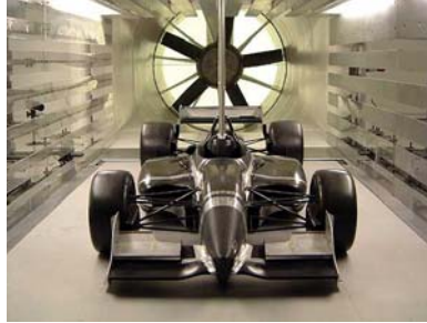
Fig. 21. Ensayo en túnel aerodinámico de coche de F1
