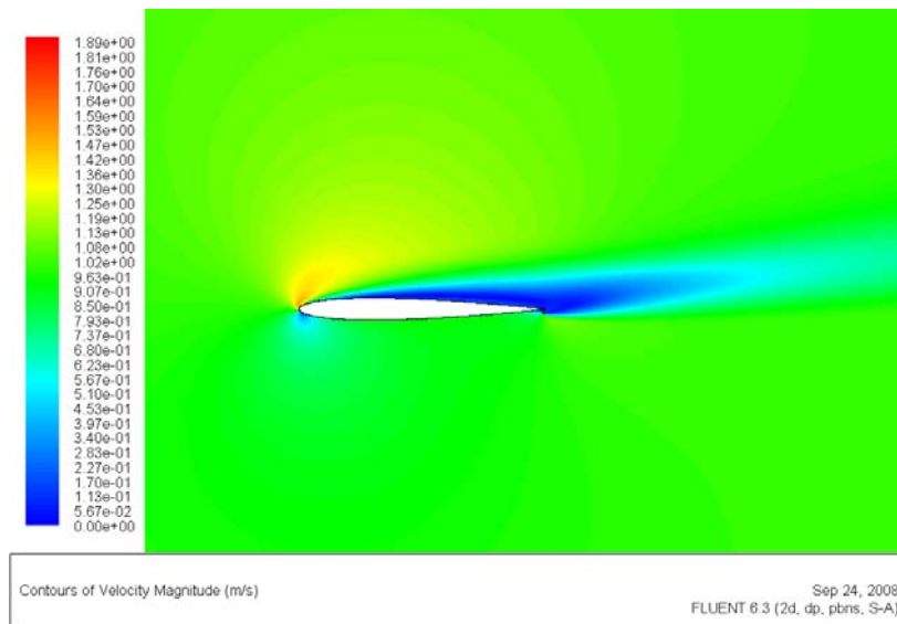
Figura 58. Velocidad del fluido para NACA 0009+2 Flap y 10° de ángulo de ataque. (Mallado C, S-A, 2º grado).
