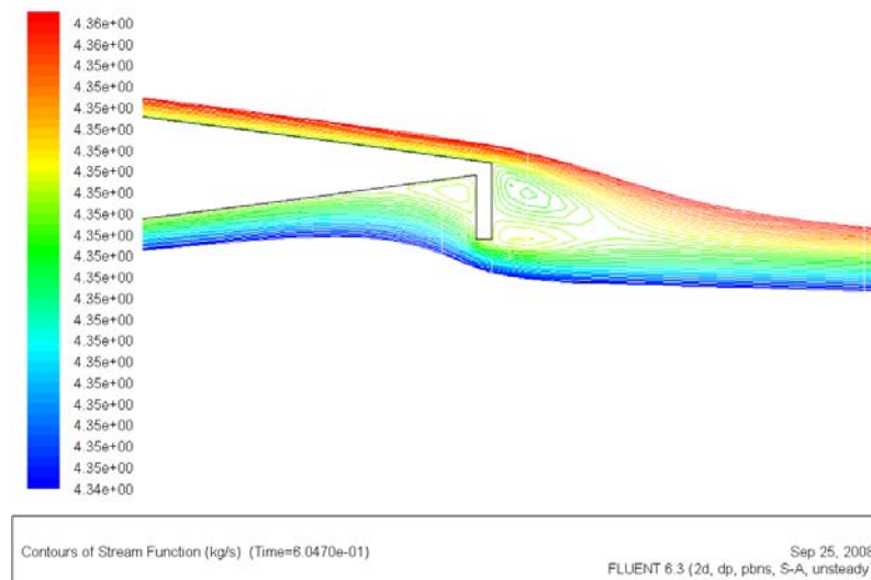
Figura 74. Líneas de corriente, NACA 0012+2 para 5º de ángulo de ataque
