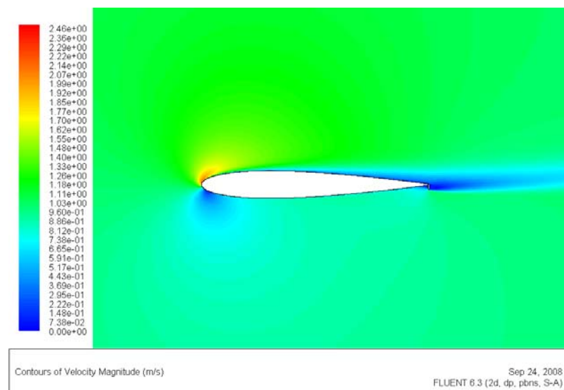
Figura 59. Velocidad del fluido para NACA 00012+2 Flap y 10° de ángulo de ataque. (Mallado C, S-A, 2º grado).
