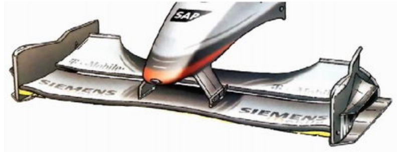
Figura 78: Detalle de alerón de alta carga con Flap Gurney
