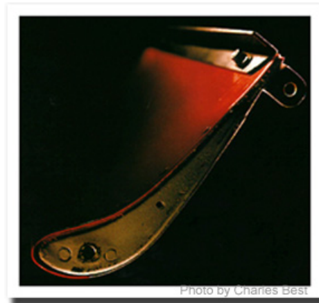
Figura. 12 Detalle de un alerón de automóvil con un flap Gurney atornillado
