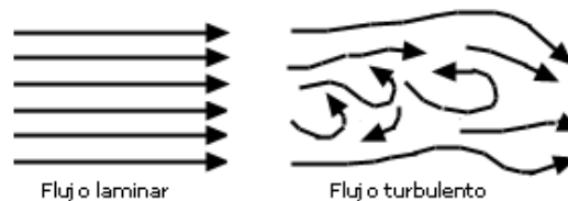
Figura. 16 Detalle de la dirección de las partículas de un fluido en régimen laminar y régimen turbulento
