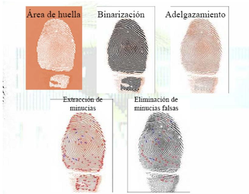
**Figura 2.7)** Detalle del procesado de una huella
