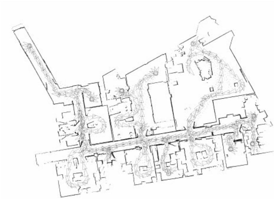
Figura 15.- Mapa del entorno obtenido mediante una técnica SLAM
