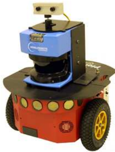
Figura 2: Ejemplo de robot con locomoción por ruedas (Pioneer 3 DX)
