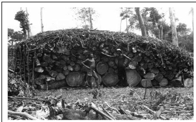
Figura 4.14. Parva de tierra durante su construcción. Observar las maderas de gran diámetro colocadas en la base de las pilas. Ghana.
