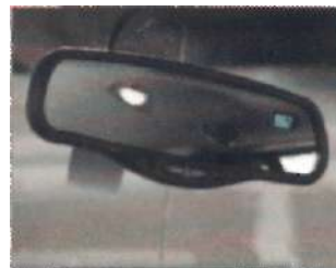
Figura 4. Espejo retrovisor electrocrómico con sensor de temperatura (Fahrenheit).
