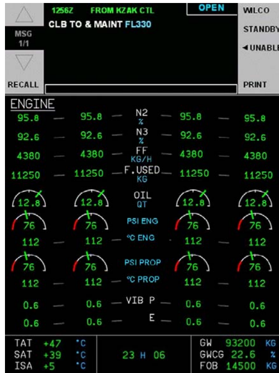
Figura 41 Detalle de los elementos que componen la pantalla del SNA del A400M
