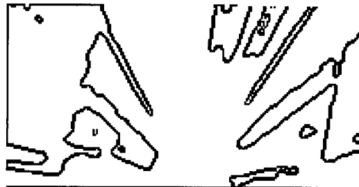
Fig. 5.28: Obtención de las fronteras. Detección de bordes.
