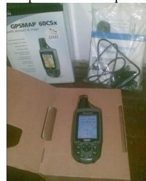
Gambar 4. Perangkat GPS Garmin GPSMAP 60CSx
