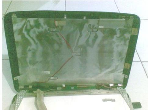
Gambar 2. Antena PIFA terintegrasi pada laptop Acer 4315
