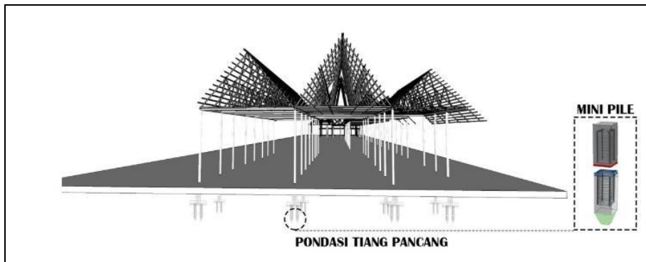
Gambar 10: Kontruksi Pondasi Pasar Sore Jalan Ampera Kota Pontianak
