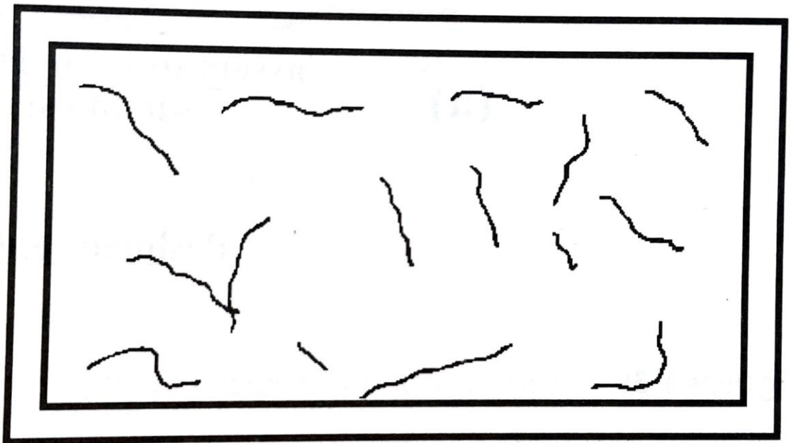
Figura 16 - Fissuras de retração em lajes em formato de mosaico.
