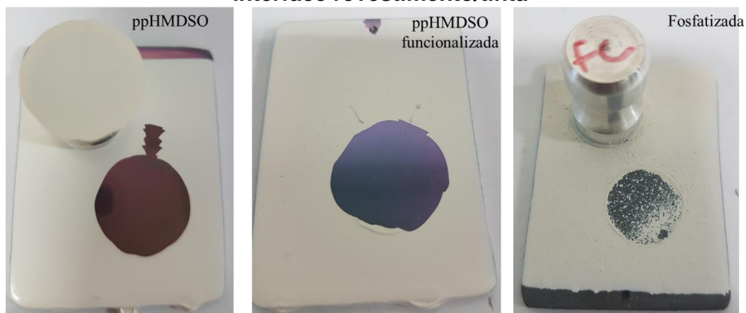
Figura 43 – Imagens das superfícies após falha de adesão destacando a interface revestimento/tinta
