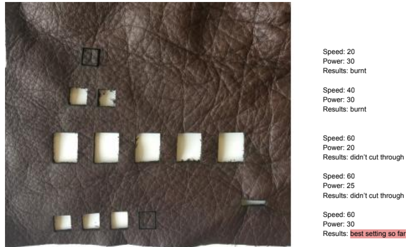
Figura 35 – Testes de configuração da máquina de corte a laser em couro
