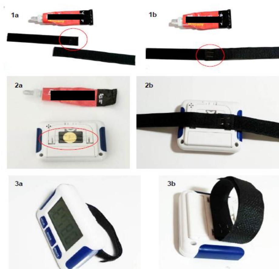
Figura 4 – Ilustração do processo de adaptação do bip digital para ser acoplado à caixa do medicamento.
