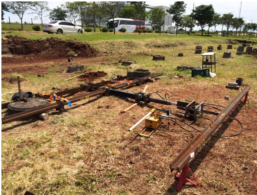
Figura 3.29 – Configuração dos ensaios de carregamento lateral (visão em campo).
