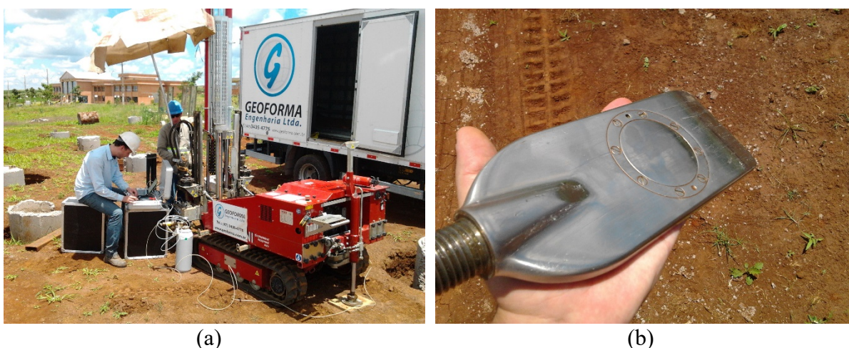
Figura 3.5 – Equipamento de cravação e cone elétrico, Faro (2014).
