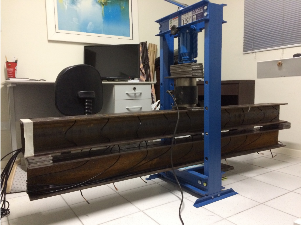
Figura 3.20 – Ensaio de calibração das estacas – hipótese de viga bi-apoiada.
