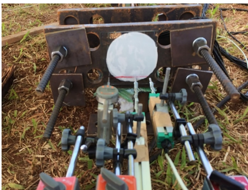
Figura 3.36 – Detalhe – posicionamento dos transdutores de deslocamento (vista).
