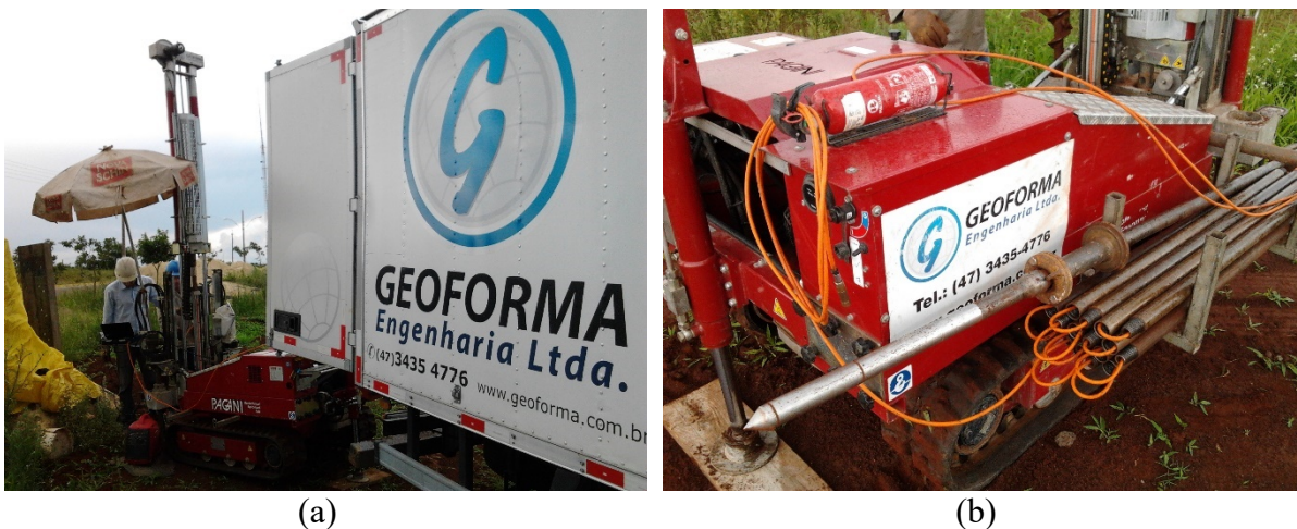
Figura 3.3 – Equipamento de cravação e cone elétrico, Faro (2014).
