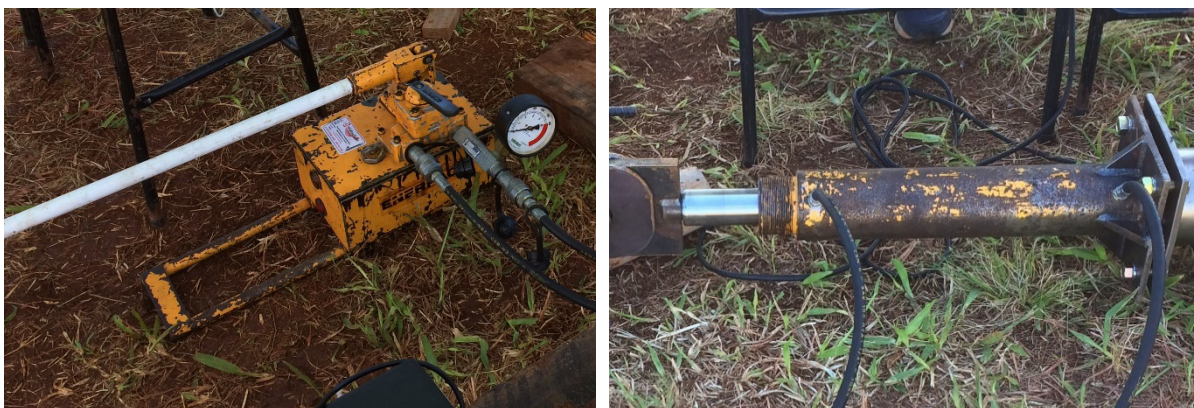
Figura 3.33 – Detalhe – macaco hidráulico – bomba + cilindro hidráulico.
