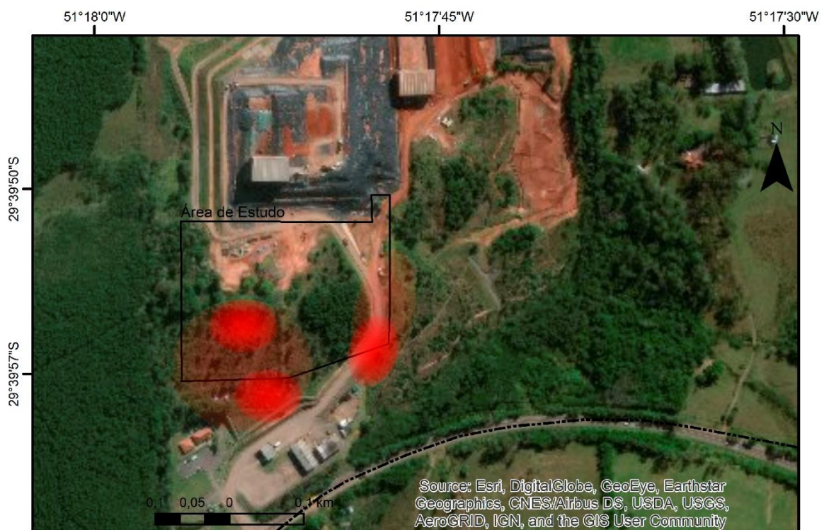
Figura 29 – Localização das regiões consideradas mais críticas quanto ao recalque.
