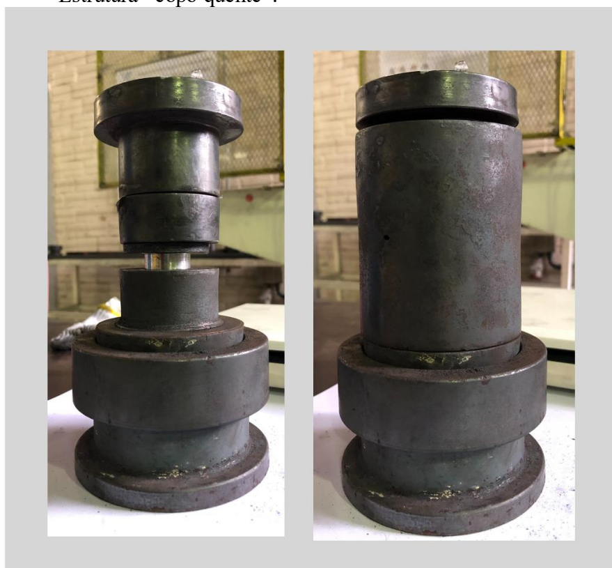
Figura 3.3 (a) Estrutura de matriz superior e inferior, corpo de prova e batente; (b) Estrutura “copo quente”.
