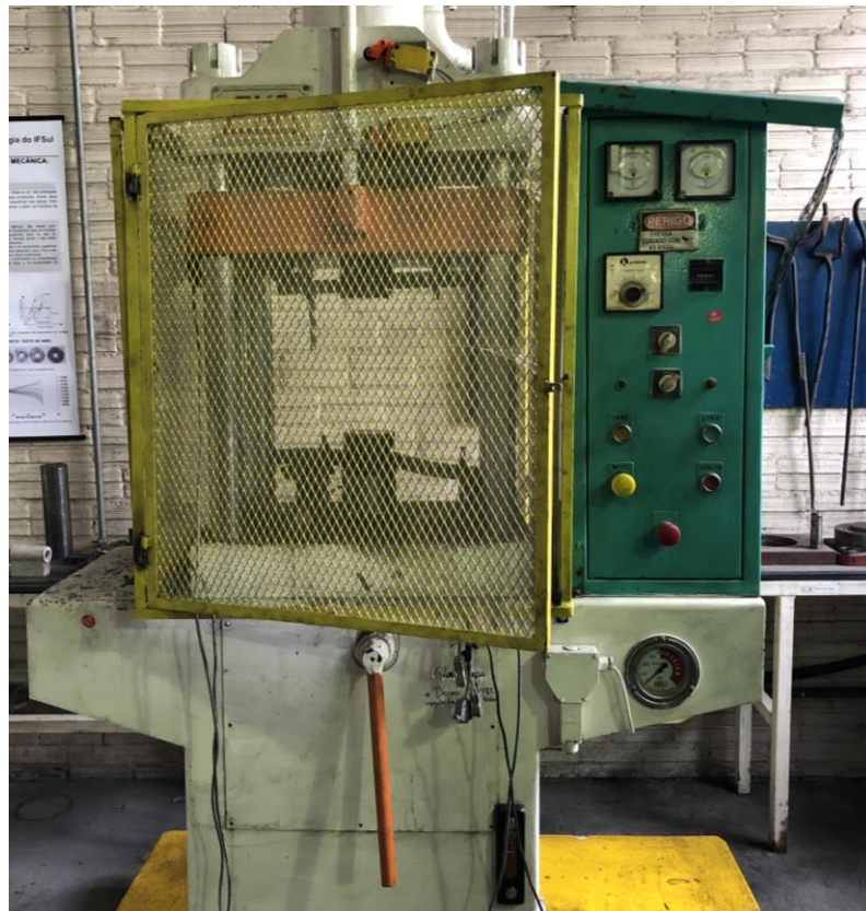
Figura 3.4 Prensa hidráulica modelo PKL40 utilizada nos ensaios.
