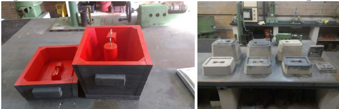
Figura 7.12: Modelo em madeira e moldes em areia curada a frio da lingoteira
