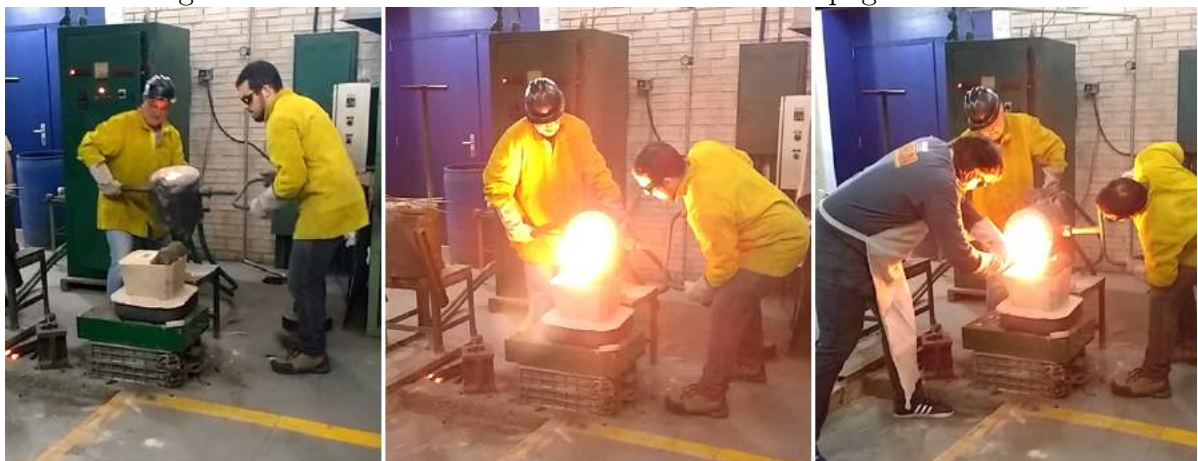
Figura 6.7: Prática de Fusão: Basculamento e raspagem do forno
