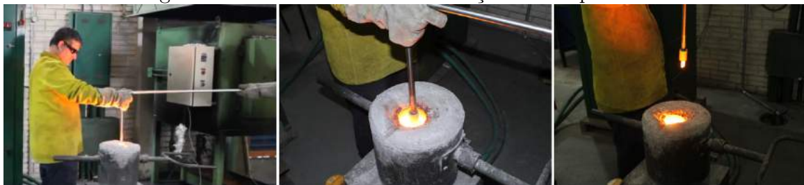
Figura 6.6: Prática de Fusão: Medição de temperatura
