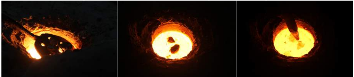
Figura 6.5: Prática de Fusão: Adição de Ferro-ligas
