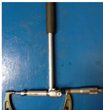
Figura 35: Comparador de diâmetro interno utilizado nas medições, sendo calibrado através do micrômetro.
