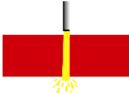
Figura 7: Processo de corte através do oxicorte Fonte: ESSEL, 2018.
