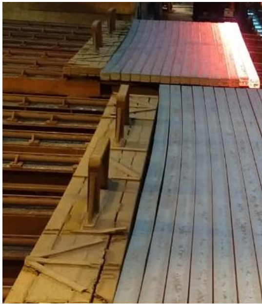
Figura 24: Defeito de empenamento no tarugo Fonte: A AUTORA.
