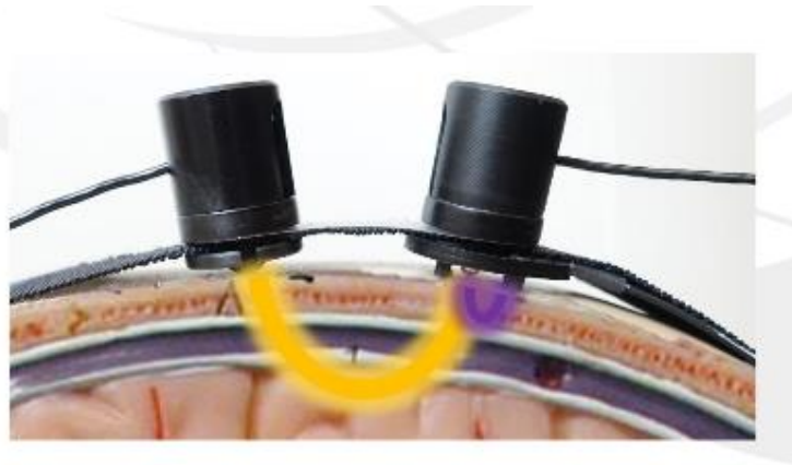
Figura 5. NIRx Help Center - Exemplo do percurso da luz do fNIRS no tecido (banana shape) para canais longos (curva amarela) e curtos (curva roxa). Canais curtos avaliam a resposta hemodinâmica superficial – pele e meninges – enquanto canais longos avaliam a resposta hemodinâmica da região cortical e tecidos superficiais.
