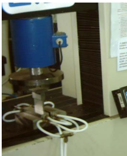
Figura 3.2: Tensiômetro e câmara de deformação posicionada para o início do ensaio.
