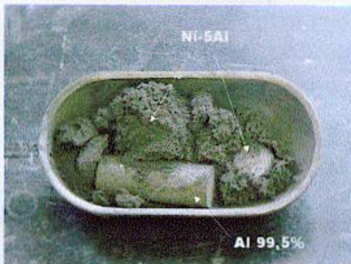
Figura 17 – Formação de coque catalítico sobre revestimentos de Ni-5Al. Amostras de Al 99,5% não apresentam formação de coque catalítico na sua superfície (amostra na parte mais inferior da figura)
